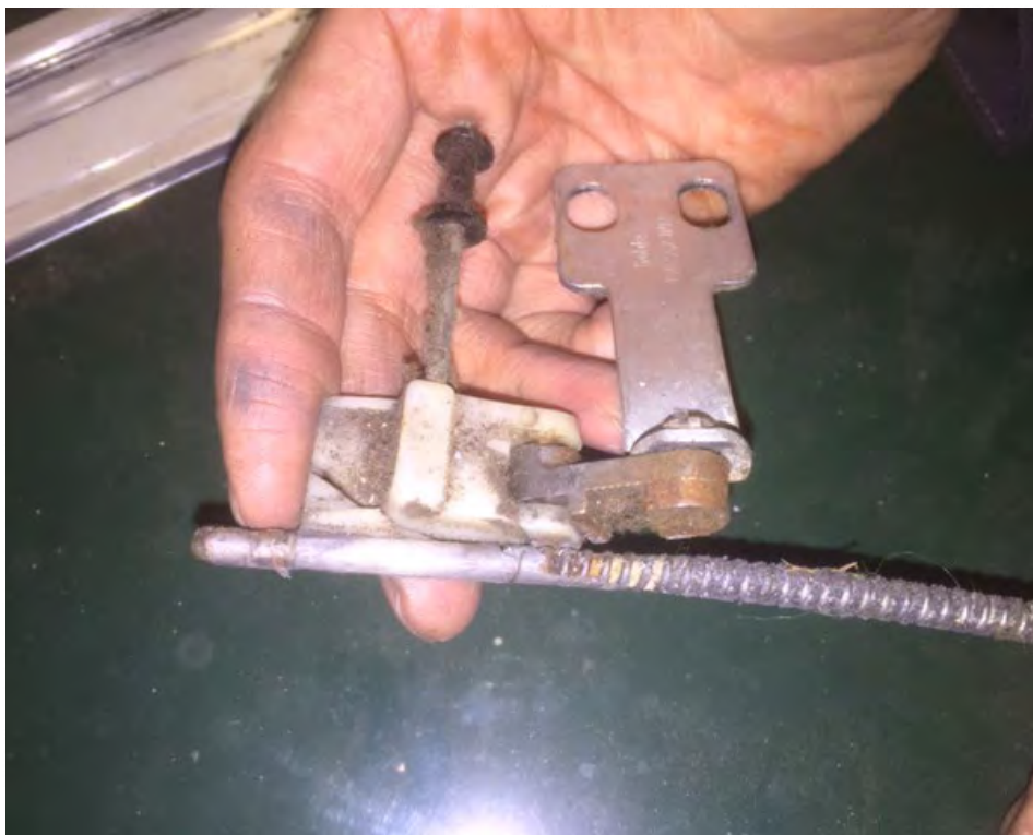
Felet med takluckan hittat. Den söndriga plastdetaljen vid en av takluckans vajrar.
